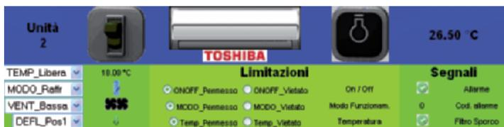
Con la sua funzione di Web Server l'i.LON-100e3 è in grado, attraverso la realizzazione di pagine web personalizzate, di controllare e gestire tutti i parametri utente degli apparecchi Toshiba e di eseguire diverse configurazioni personalizzabili.
